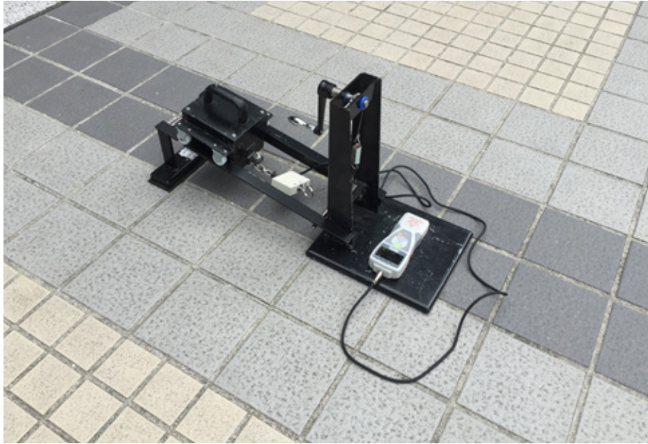
4.ONO-PPSM 可攜帶式防滑試驗機
